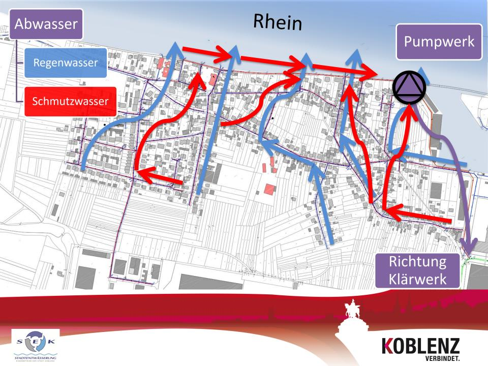
Abwasser Pumpwerk lm Sändchen GOK 65,60 HQ100 ca. 66,60 66,60 65,60 KOBLENZ VERBINDET. STADTENTWÄSSERUNG
