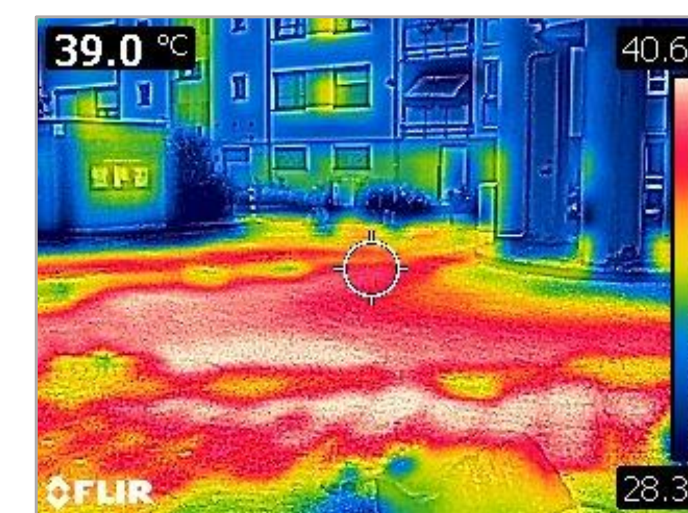
Abbildung 1: Wärmebildaufnahmen des Kirchenvorplatzes am 06.06.2023 zeigen die hohe Temperatur der gepflasterten Fläche im Vergleich zur kühleren Umgebung (heißer bewölkter Tag; 30^\circ\text{C} )
