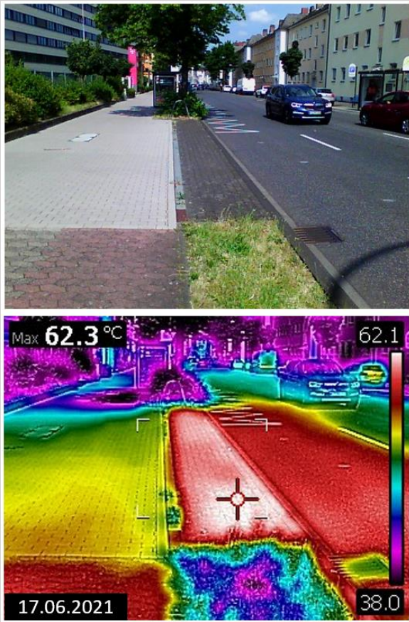
Abbildung 8: Oberflächentemperatur Pflasterbelags in der Moselweißer Straße
